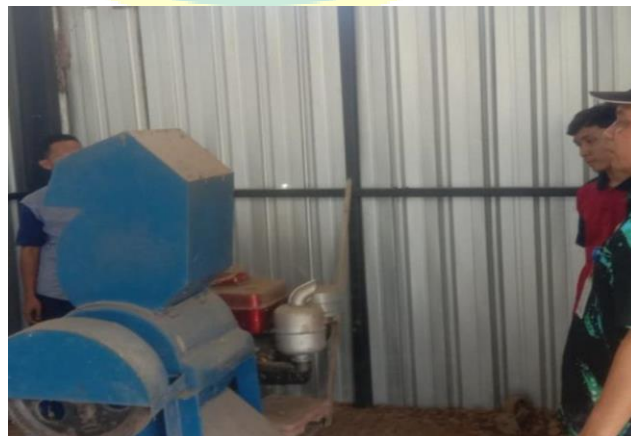
Gambar 4. Alat Pencacah Sampah Plastik
