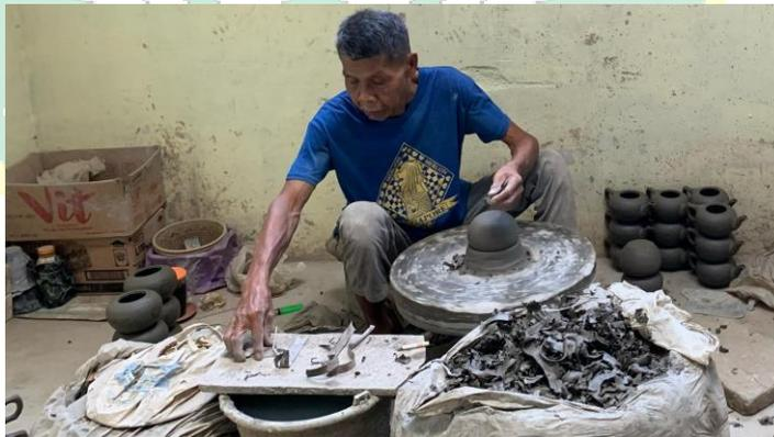
**Gambar 4. 3 Proses pembuatan keramik teknik putar di Keramik Mustika Klampok**
