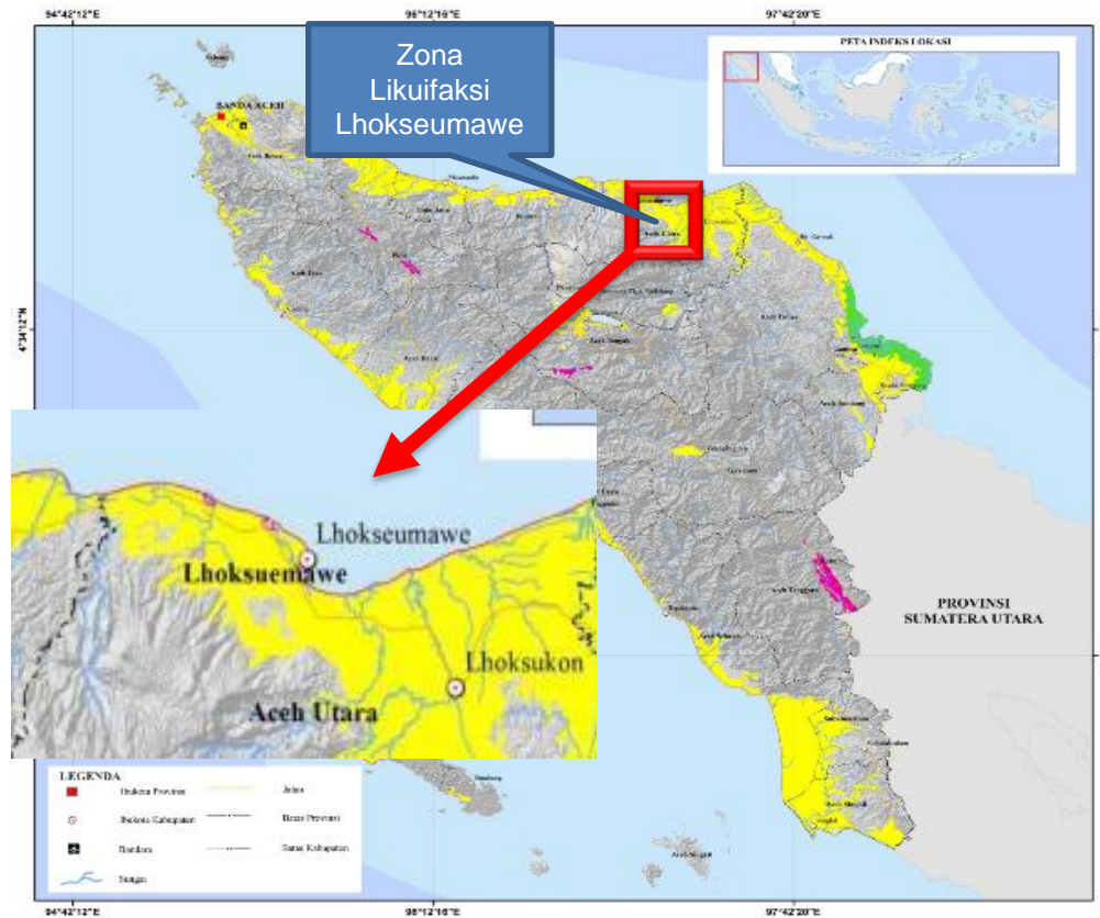
Gambar 1 Peta zona kerentanan likuifaksi di Aceh Sumber: Badan Nasional Penanggulangan Bencana, (2019)
