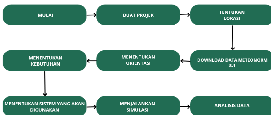
Gambar 2. Diagram alir simulasi dengan PVsyst 7.3
