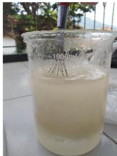
Gambar 5. Mengaduk larutan campuran KOH, Aquades dan minyak kelapa menggunakan mixer tangan
