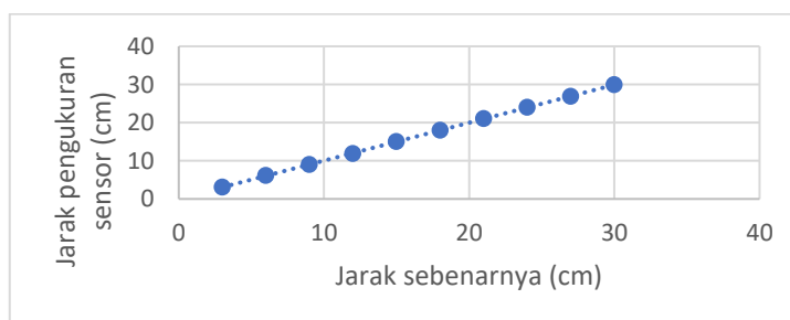
Gambar 4. Hasil Pengujian Sensor Ultrasonik
