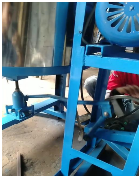
Gambar 9 Komponen Penggerak Dongkrak
