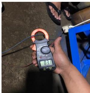
Gambar 6. Hasil pengukuran arus menggunakan ac clamp meter tanpa beban pamarutan
