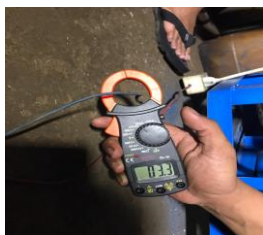
Gambar 7. Hasil pengukuran arus menggunakan ac clamp meter ketika ada beban pamarutan
