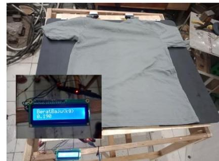
Gambar 10. Hasil Deteksi Load Cell Baju 30S
