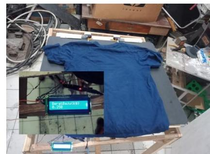
Gambar 11. Hasil Deteksi Load Cell Baju 20S
