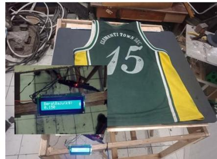
Gambar 9. Hasil Deteksi Load Cell Baju 40S
