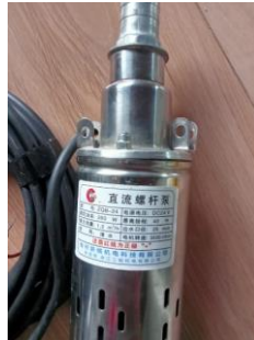
Gambar 4.1. Pompa air submersible dc.
