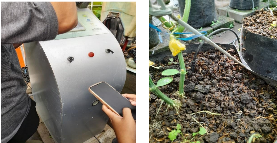
Gambar 1. Mesin penyiram otomatis (dripstik)
