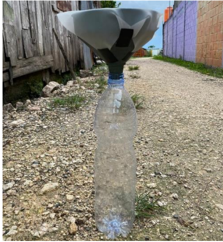
Gambar 6. Alat Filtrasi Air Sumur Tanah Tampak Depan
