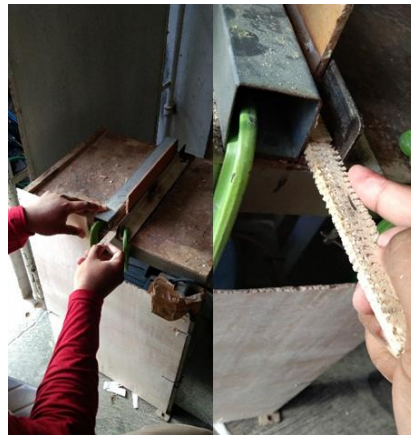
Gambar 2 proses pemotongan modul pipih bonggol jagung menjadi 2 bagian menggunakan table saw sumber: dokumentasi pribadi
