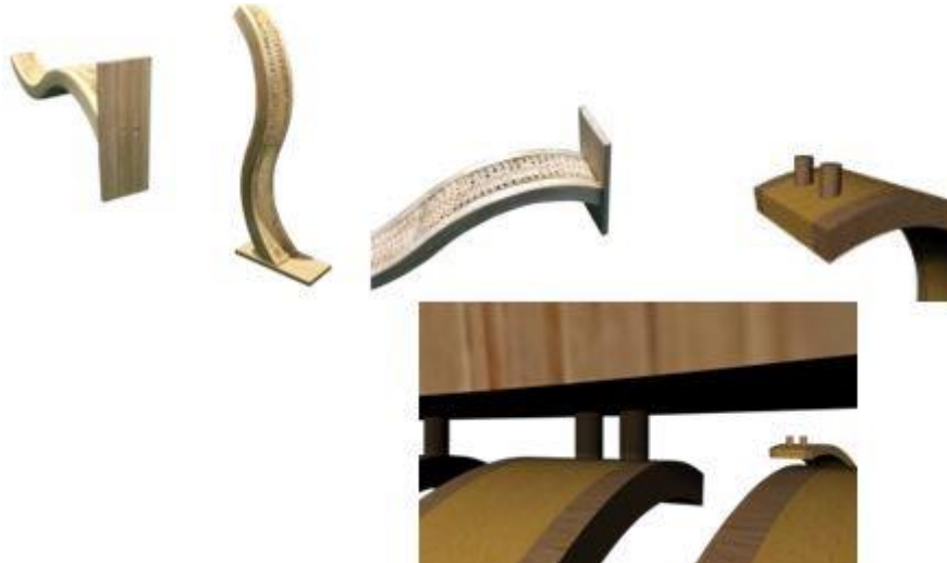
Gambar 19. Skema jointing pada produk servingware sumber: dokumentasi pribadi
