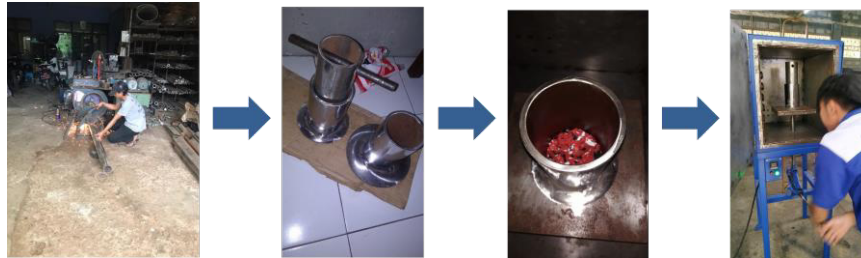
Gambar 10. Proses perakitan cetakan dan pemanasan Sumber : Data Pribadi
