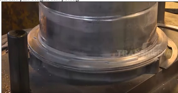
Gambar 9. Pemotongan sisa plat Sumber : youtube
