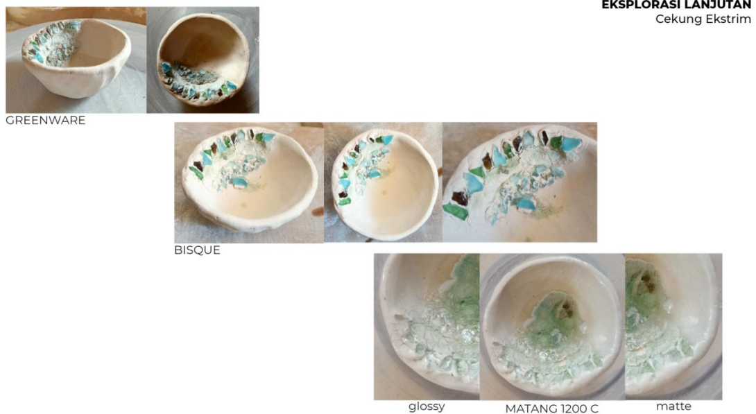
Gambar 11. Cekung Ekstrim dengan finish glasir glossy (kiri) dan matte (kanan) pada suhu biskuit 800 C dan suhu matang 1200 C Sumber : Dokumentasi Penulis
