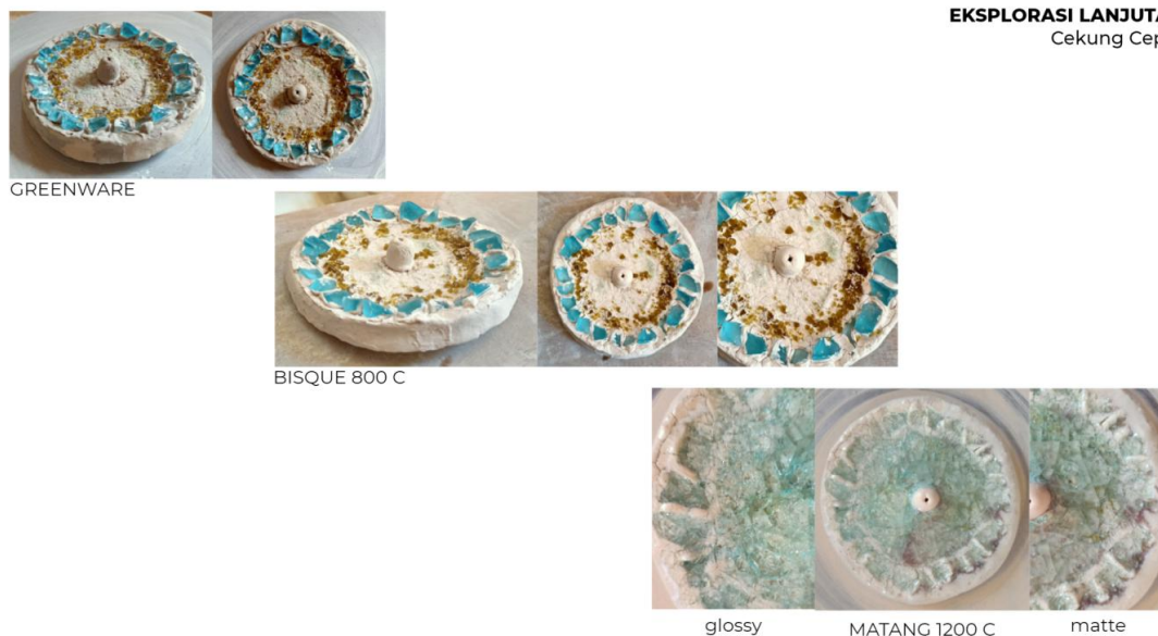
Gambar 7. Cekung Ceper dengan finish glasir glossy (kiri) dan matte (kanan) pada suhu biskuit 800 C dan suhu matang 1200 C
