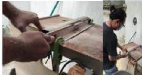
Gambar 3 proses pemotongan modul pipih bonggol jagung menjadi 2 bagian menggunakan table saw sumber: dokumentasi pribadi
