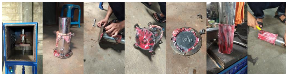
Gambar 12. Proses pembuatan setelah cetakan dimodifikasi Sumber : Data Pribadi
