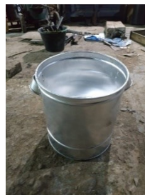
Gambar 30. Tabung kondensor Sumber : Dokumentasi Penulis
