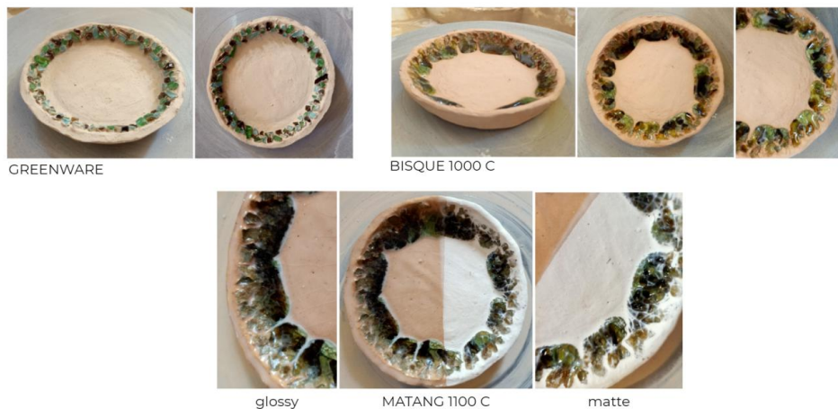
Gambar 6. Cekung Ceper dengan finish glasir glossy (kiri) dan matte (kanan) pada suhu biskuit 1000 C dan suhu matang 1100 C
