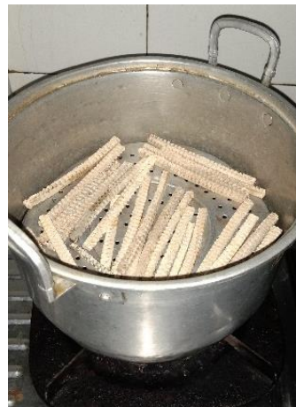
Gambar 5 proses pengukusan potongan modul balok bonggol jagung, Sumber: Dokumentasi pribadi
