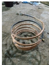
Gambar 31. Pipa pendingin Sumber : Dokumentasi Penulis
