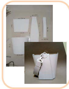
Pembuatan Pola dan modelling dengan bahan duplex / busa ati.
