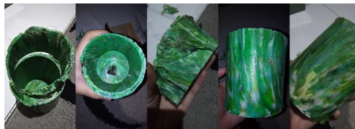
Gambar 15. Hasil percobaan keempat dengan cetakan besi pipa Sumber : Data Pribadi
