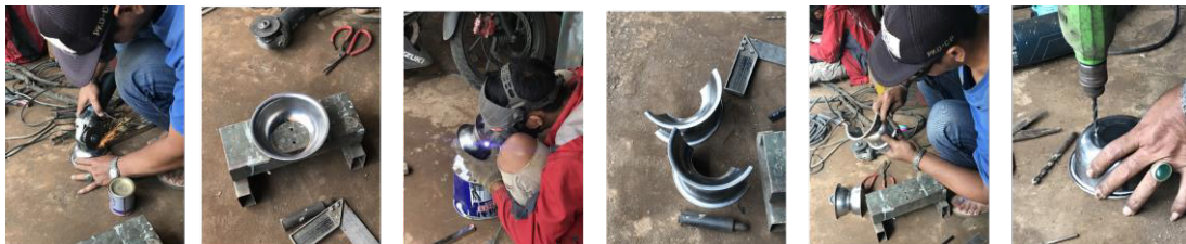
Gambar 8. Proses pembuatan cetakan berbahan mangkuk aluminium Sumber : Data Pribadi
