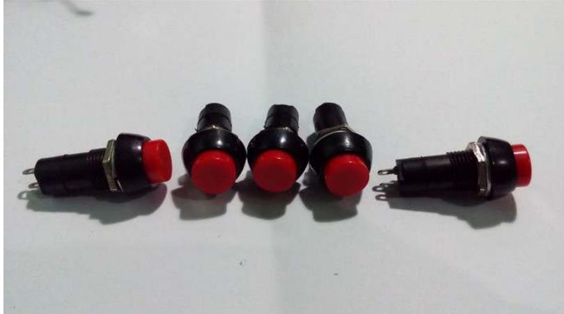
Tombol Reset bermanfaat untuk mengulang kembali suatu proses pada IoT yang di buat
