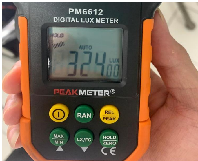
Gambar 11 Hasil Pengukuran cahaya dengan duty cycle 50%
