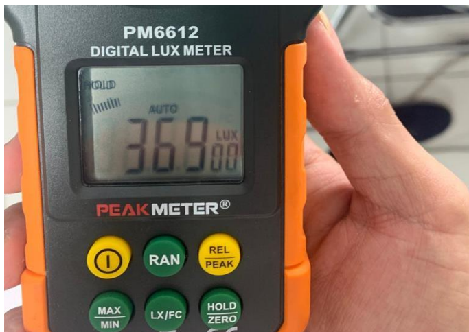
Gambar 17 Hasil Pengukuran cahaya dengan duty cycle 90%
