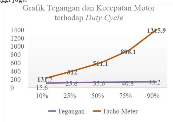
Gambar. 8 Grafik Tegangan dan Kecepatan Motor terhadap duty cycle
