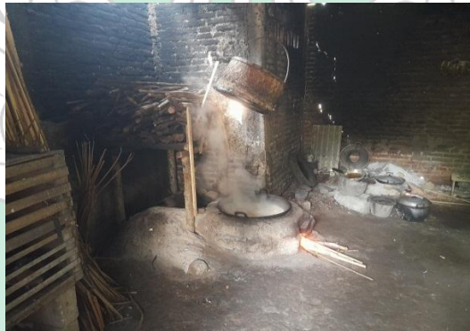
Gambar 3. 14 Proses produksi perebusan air nira yang diproduksi oleh penderes kelapa
