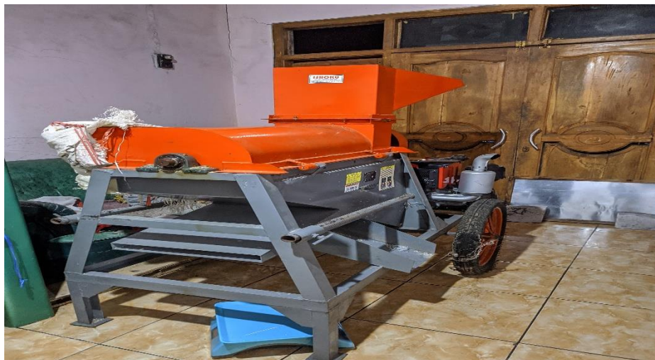
Gambar 1.13 Alat Pemotong Tembakau
