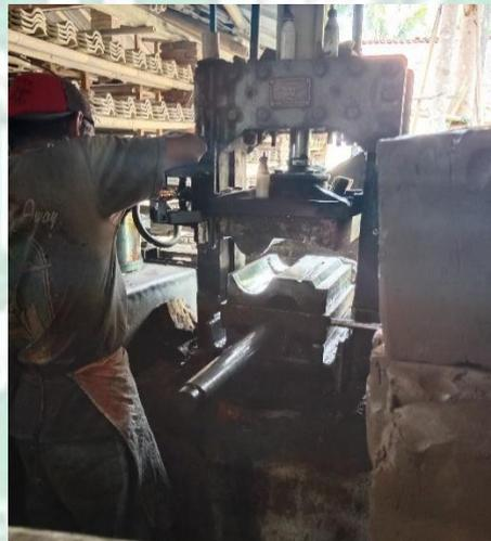
Gambar 5 Proses pencetakan genteng melalui alat press
