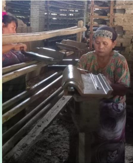
Gambar 6 proses pemotongan
