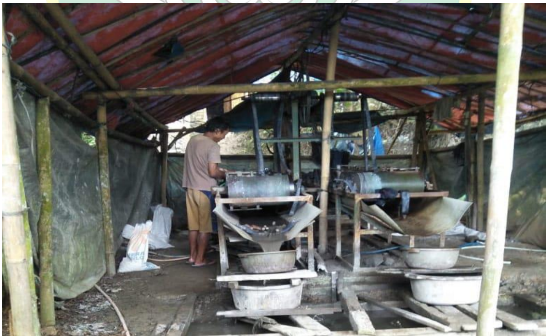
Gambar 14: Alat pengolahan tanah liat mengandung emas Desa Cihonje Gumelar Banyumas, foto diambil pada hari Jum'at, 22 Desember 2023
