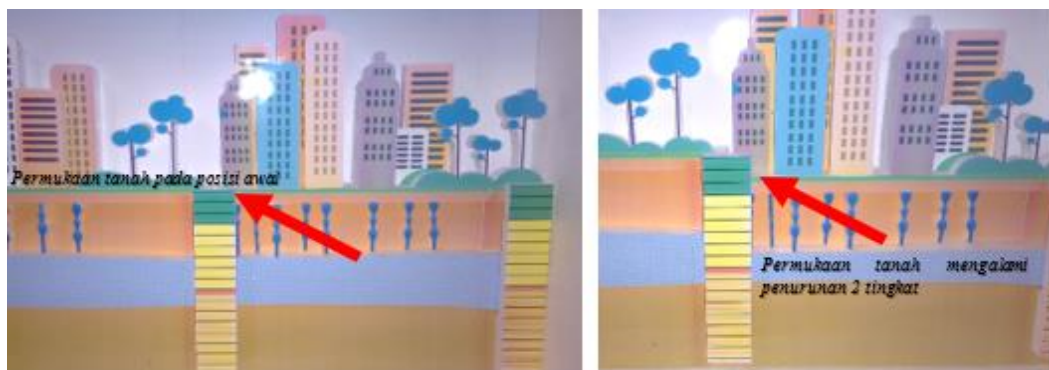
Gambar 2 : Ilustrasi penurunan muka tanah pada media BERIBU
