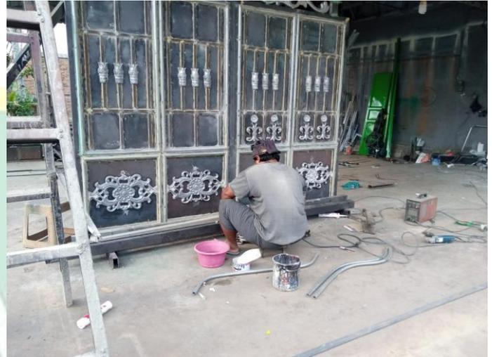
*Gambar 2. Proses Pembuatan Tralis di UMKM Ozi*
