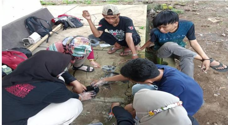
Gambar 10. Percetakan biobriket manual dengan pipa paralon
