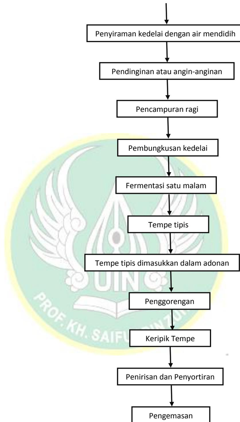
Gambar 1. Proses Produksi Pembuatan Keripik Tempe *Home Industry* Keripik Tempe Kiki Warni
